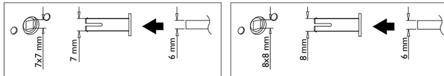
**Hinweis** Beim Einsatz von BAD Schlössern mit 7 mm bzw. 8 mm Nussvierkant bitte immer die passende beiliegende Hülse (selbstverriegelnd) verwenden.
