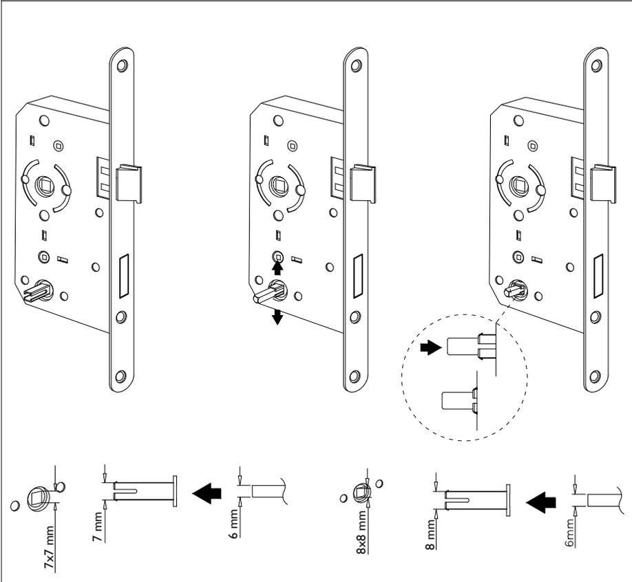
**Hinweis** Beim Einsatz von BAD Schlössern mit 7 mm bzw. 8 mm Nussvierkant bitte immer die passende beiliegende Hülse (selbstverriegelnd) verwenden.
