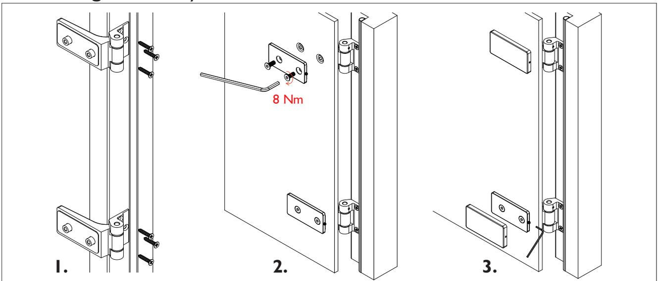
1. Legen Sie den genauen Sitz des Bandes anhand der beiliegenden Zeichnungen fest. Befestigen Sie das Türband im Falz. Verwenden Sie beiliegende Schrauben oder bauseits geeignete Schrauben bzw. Dübel
