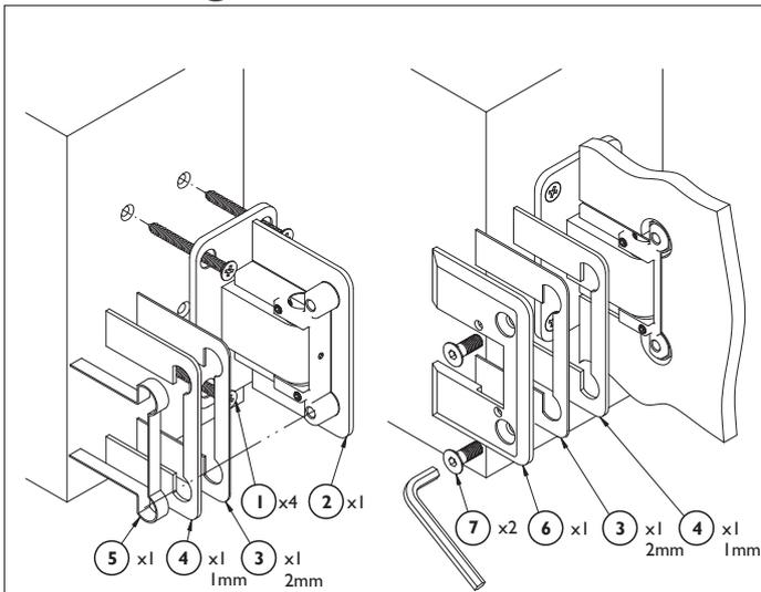
Befestigen Sie den Grundkörper des Pendeltürbandes an der Wand oder der Zarge. Überprüfen Sie vor der Montage die Tragfähigkeit des Untergrundes. Verwenden Sie zur Verschraubung dem Untergrund entsprechende Befestigungslösungen.
