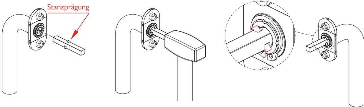
Führen Sie die Schrauben in die Unterkonstruktion des Fenstergriffs ein und stecken Sie den Fenstergriff auf den Fensterrahmen. Anschließend kann der Griff mit geeigneten Schrauben in passender Länge befestigt werden.
