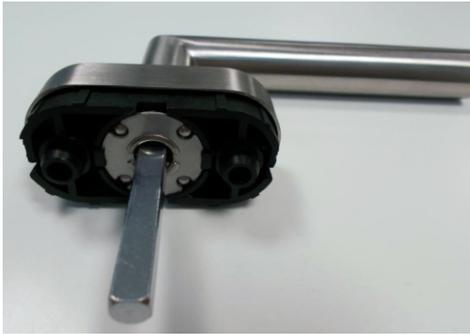
Der Stift in der benötigten Länge muss danach in den Griff eingeschlagen werden. Damit wird ein fester Sitz des Griffes gewährleistet und ein Herausfallen des Stiftes in das Fensterprofil verhindert. Den Stift bis zur Stanzkante in den Stiftkanal des Fenstergriffes einführen.
