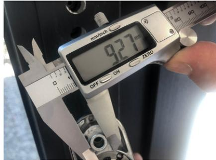
Weiterhin sollte mit einer Tiefenmessung die Länge der Schrauben und des Stiftes bestimmt werden.
